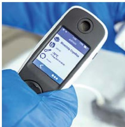
Identification instantanée des échantillons à des températures allant jusqu'à -196 °C, même avec présence de givre
