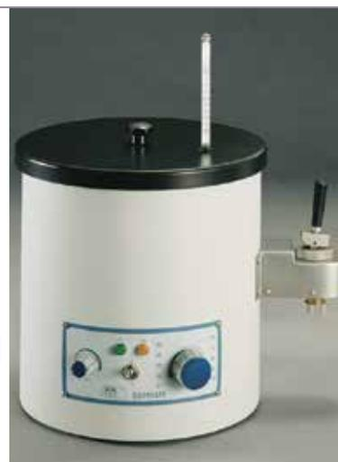
Pour températures réglables de l'ambiante +  $5^\circ\text{C}$  jusqu'à  $100^\circ\text{C}$ . Stabilité  $\pm 1,5^\circ\text{C}$ . Panneau de commande :
