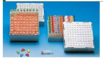
Boîtes en polycarbonate, autoclavables, à couvercle coiffant.
